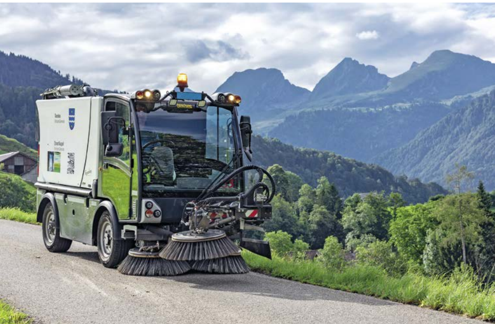
Die Boschung S3 der Gemeinde Ebnat-Kappel (Kanton St. Gallen) arbeitet mit Recyclingbürsten und kommt leihweise auch in Nesslau zum Einsatz.
